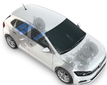
Polo TGI mit neuem Tanksystem
