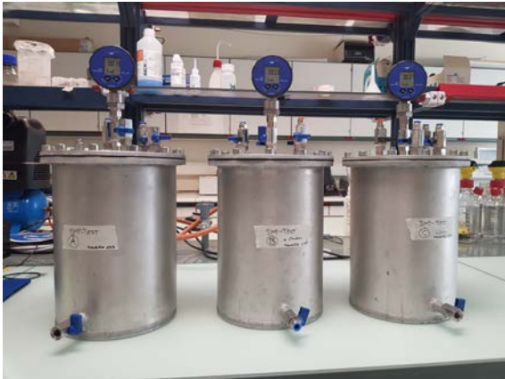
BMP Tests im Labor (3.5L Reaktoren)
