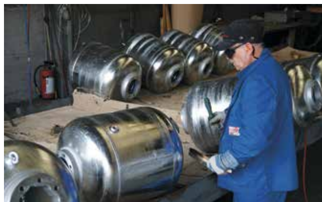
Après la galvanisation, les pièces sont contrôlées et retravaillées à la main.
