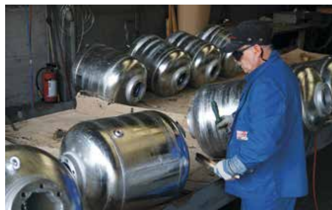
Nach dem Verzinken werden die Werkstücke kontrolliert und von Hand nachbearbeitet.
