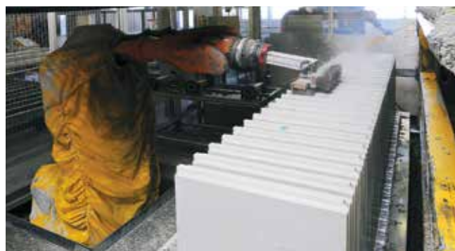
Le robot nettoie les plaques de plâtre.
