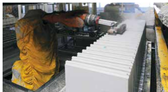
Der Roboter reinigt die Vollgipsplatten.
